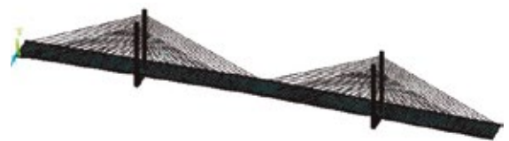
Figura 2. Modelo MEF del Puente Río Papaloapan. Fuente: IMT (2025).
