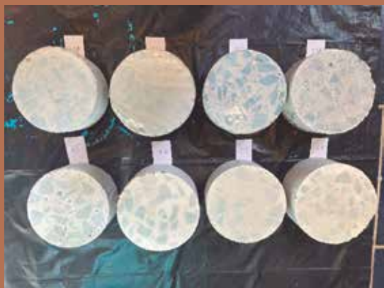
Figura 2. Ítems de concreto recubiertos con geopolímero.
