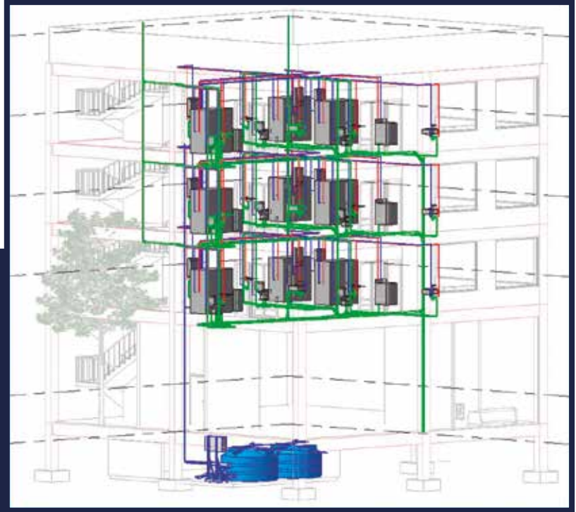
Figura 2. Ejemplo de instalaciones MEP en edificio habitacional.
