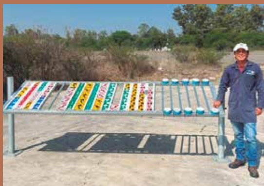
Figura 3. Núcleos de concreto recubiertos expuestos al ambiente.
